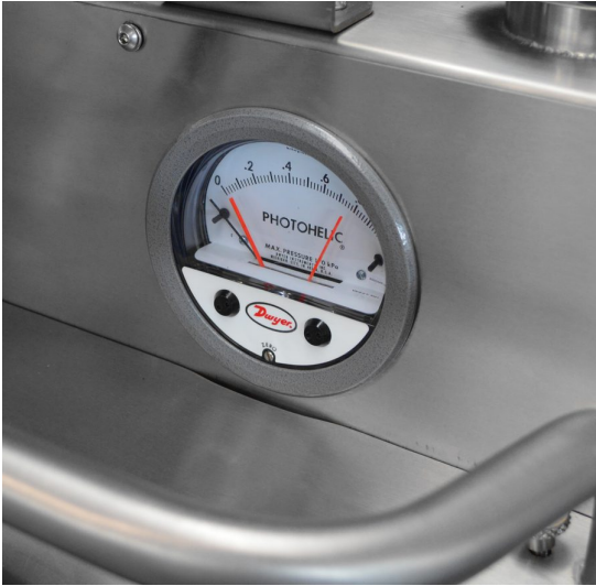
Photohelic filterindikator til Delfin SEP.DC-011
