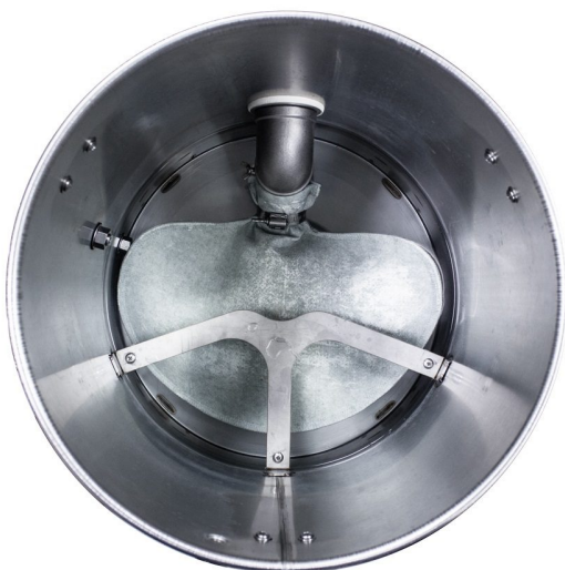
Konduktiv våd opsamlingspose med holder installeret i beholderen
