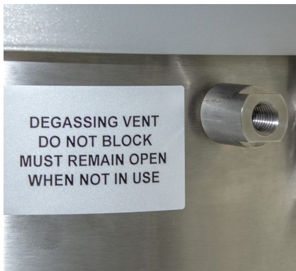
Afgæsningsventil på C-10 EX — må ikke blokeres
