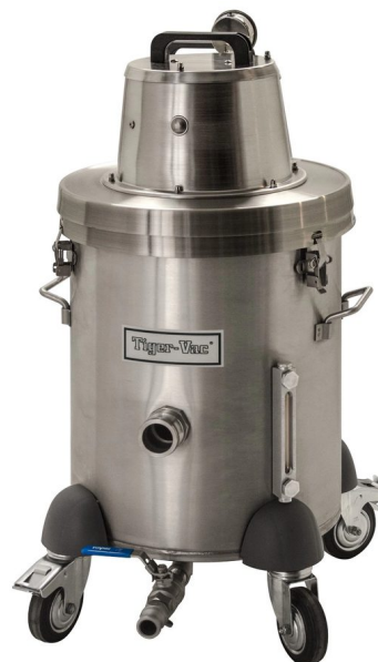
Tiger-Vac ATEX-10A (IT-40L) CFE HEPA — pneumatisk ATEX II 2GD vandimmersionssuger til brændbart metalpulver
