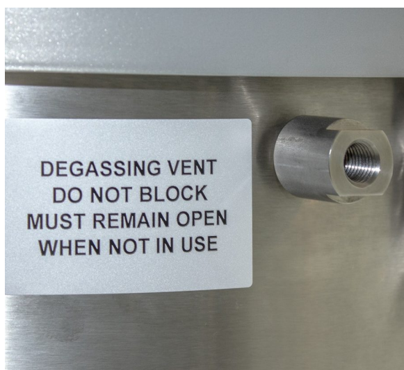
Afgæsningsventil på ATEX-10A — må ikke blokkeres
